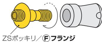
③ セットしたZSインサートとZSポッキリを型枠のねじにねじ込む
